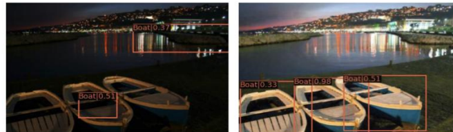
Low-light 환경에서 Object detection 추론 실패 예시 1)
